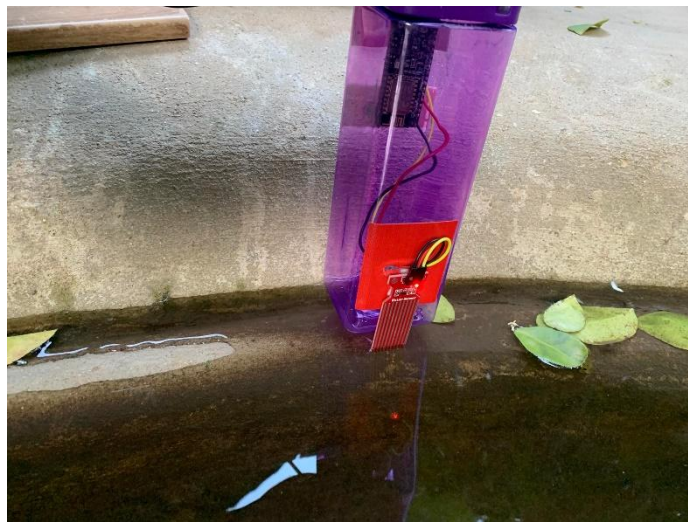
ภาพที่ 5 การติดตั้งเครื่องแจ้งเตือนน้ำล้นบ่อปลาผ่านแอปพลิเคชันไลน์
